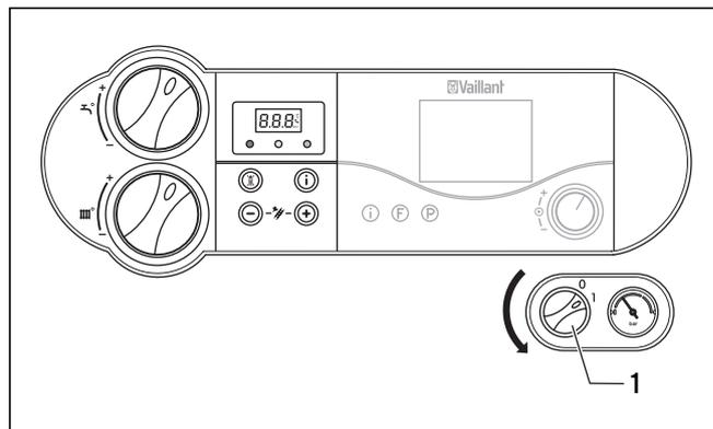
Рис. 4.16 Отключение прибора
