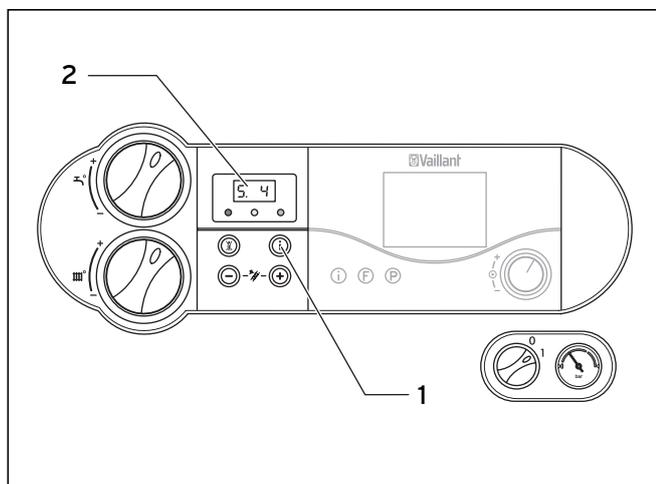
Рис. 4.12 Индикация состояний
