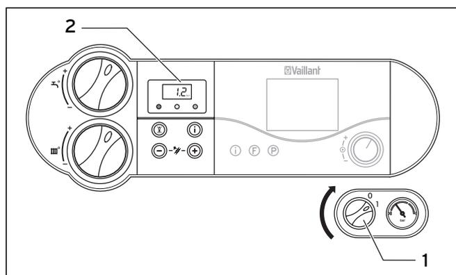
Рис. 4.5 Включение прибора
