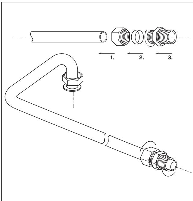
Рис. 4.2 Подключение газа
