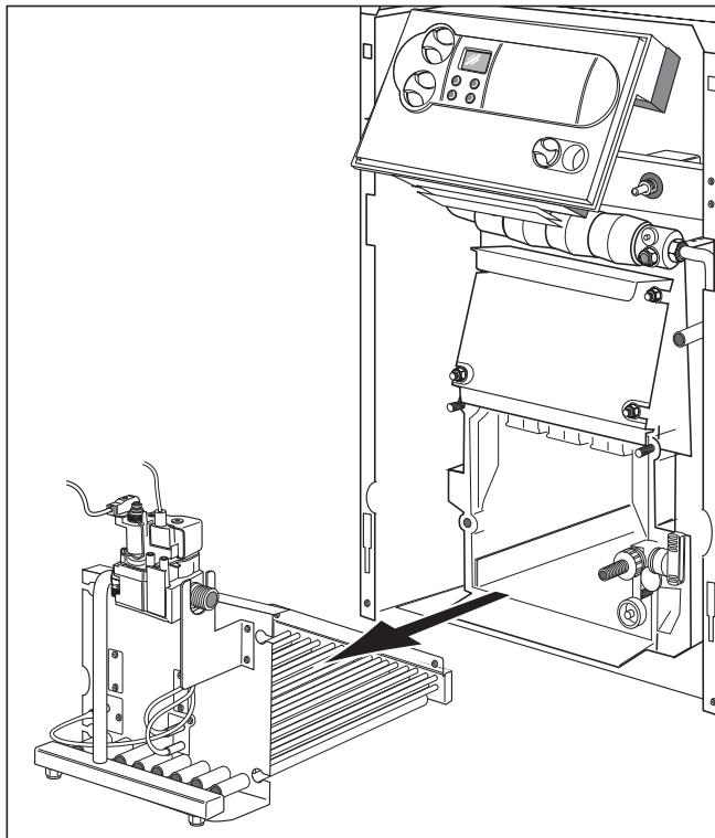
Рис. 7.1 Демонтаж горелки
