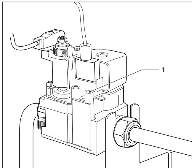
Рис. 5.1 Измерение входного давления на измерительном штуцере
