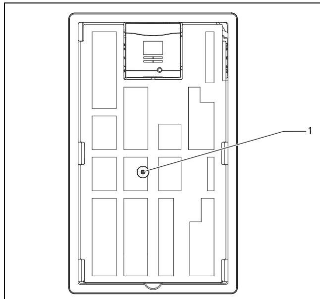
1 Кріпильний гвинт
