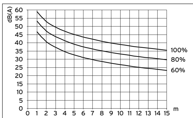
Мал. 6.5 Рівень звукового тиску двох зовнішніх модулів в дБ(A) залежно від віддаленості й числа оборотів вентилятора для VWL 171/3 S при установці у вільному звуковому полі
