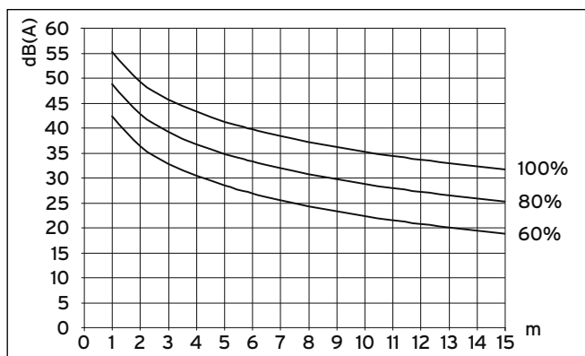
Мал. 6.4 Рівень звукового тиску двох зовнішніх модулів в дБ(A) залежно від віддаленості й числа оборотів вентилятора для VWL 141/3 S при установці у вільному звуковому полі
