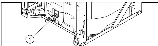
4. Підключіть шланг до патрубка зливного крана (1) і виведіть вільний кінець до підходящого місця стоку.
