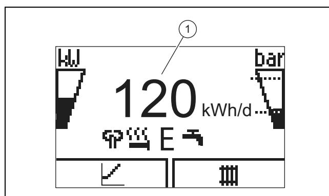
На дисплеї відображається основна індикація з поточним станом виробу. У центрі дисплея відображається денний внесок енергії (1).
