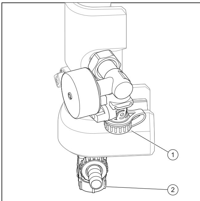
4. Підключіть шланг до зливного крана (1) та (2) виведіть кінець шланга до підходящого місця стоку.
