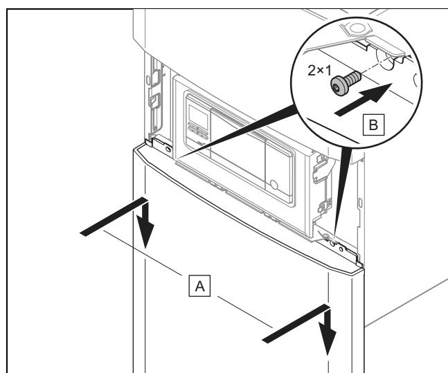
2. Навісьте нижню частину переднього облицювання з кріпильними кутами в заглиблення бічних частин обшивки та заглибіть її.
