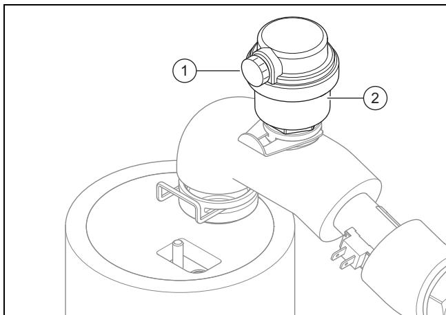
7. Відкрийте гвинт для видалення повітря (1) на швидкодіючому пристрії видалення повітря (2), щоб видалити повітря з виробу.
