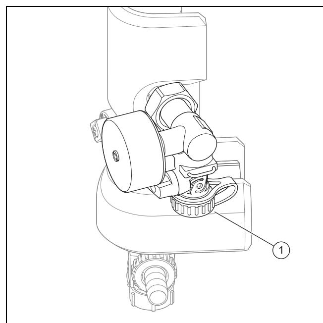
5. Підключіть кран заповнення до наповнювального та спорожнювального крану (1).
