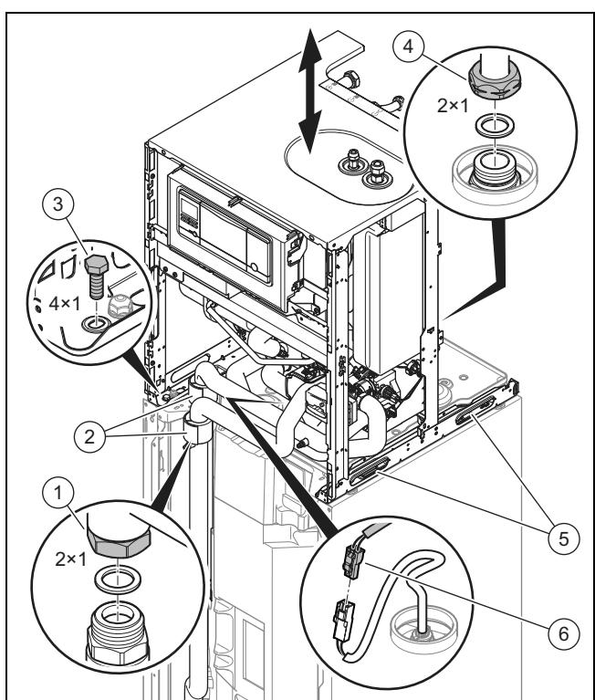
4. Пересуньте теплоізоляцію (2) на трубних перевідниках вгору.
